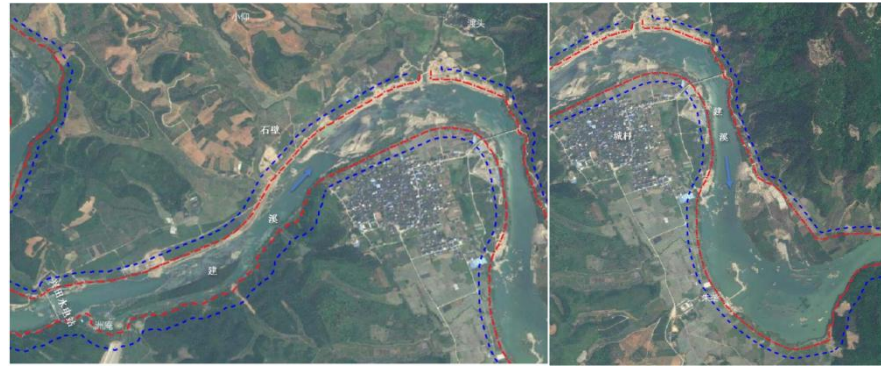
图 4.2-14 场地防洪划岸线示意图
