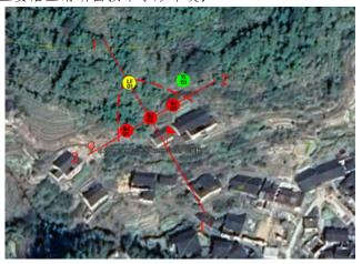
❖ 潜在方量<5000m³~10000m³: 8 套设备,雨量+地表裂缝+倾角+摄像头+声光报警器(8),设备主要沿主崩滑断面按十字形布设;
