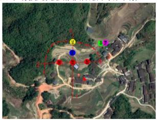
◆ 潜在方量<10000m³~10×10⁴m³:8~9套设备,(含水率1)+雨量+地表裂缝+倾角+摄像头+声光报警器(7~8),设备主要沿主崩滑断面布设,根据实际情况按十字形布线或▶形或→形布设;
