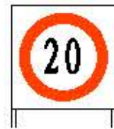
图3-2 前方施工限速标志图
