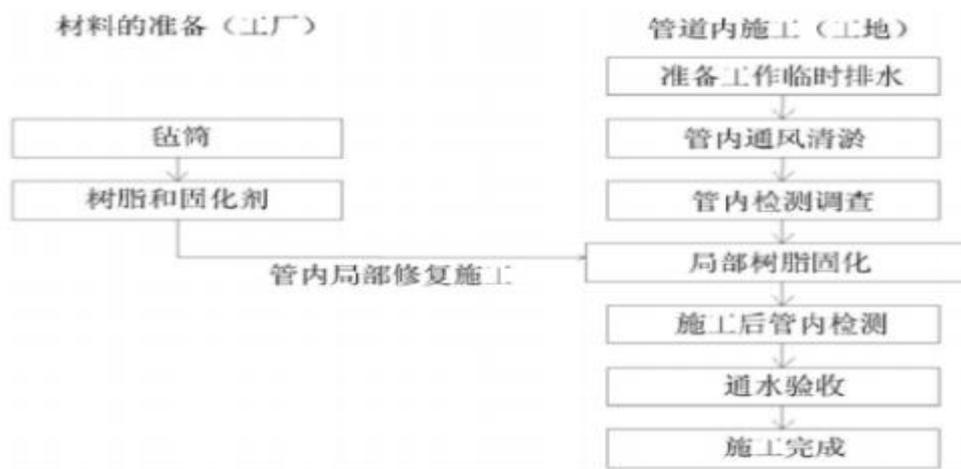
图 6-8 局部树脂修复施工工艺流程
